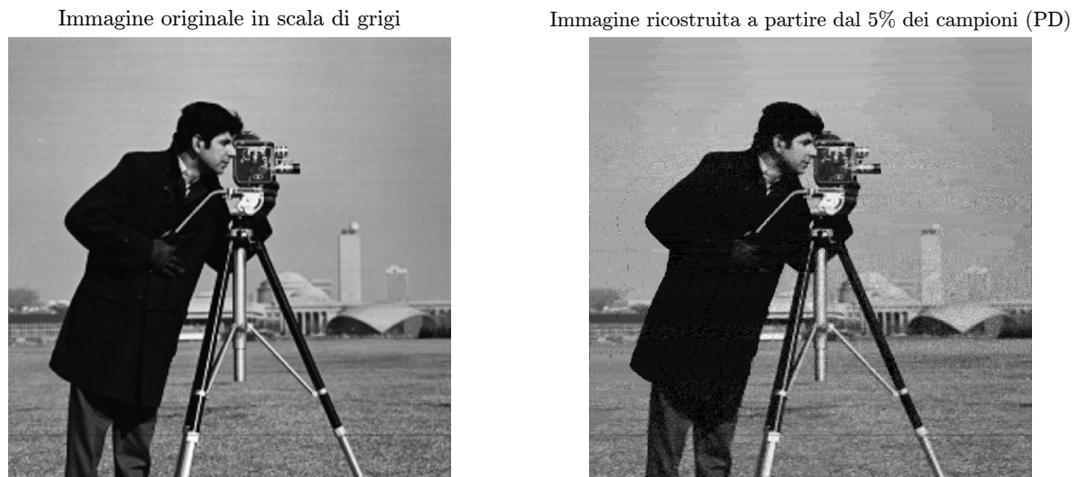
Figura 5.24: Degrado nella ricostruzione a partire dal 5% dei campioni (EOT)
